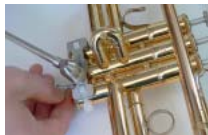
... und dann das Tragegestänge mit Hilfe eines Splints arretiert. So hat die Konstruktion die nötige Stabilität.
